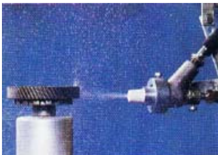
研磨材を高速で吹き付けるサンドブラスト加工
