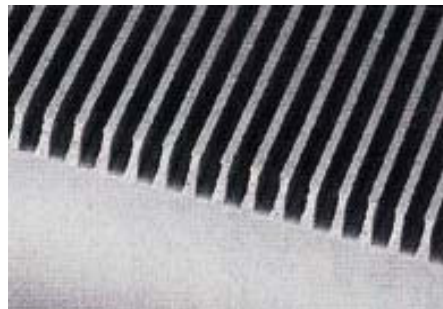
同装置で加工したPDP心臓部・リブ部分
