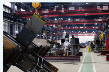
建築鉄骨の柱 工場の様子
