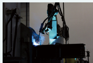
ロボット溶接の様子
