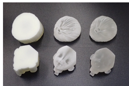
画像左側：工程 1 3D プリンター出力後 画像中心：工程 2 サポート材除去後 画像右側：工程 3 Pollux による磨き後
