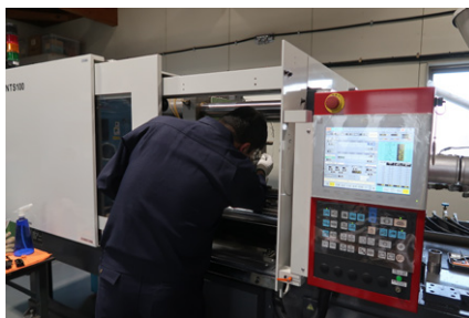
インサート成形作業の様子
