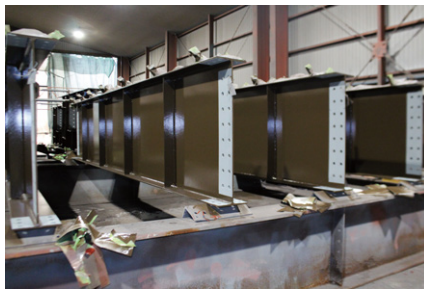
ブラスト処理後 上塗りまで行った橋桁
