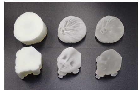
画像左側：工程 1 3D プリンター出力後 画像中心：工程 2 サポート材除去後 画像右側：工程 3 Pollux による磨き後
