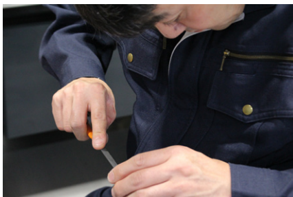
従来の手作業（ヤスリ）によるバリ取り
