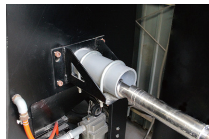
側面の長尺スクリー挿入口（フルヤ様のご要望で装置をマットブラックで塗装しております。）
