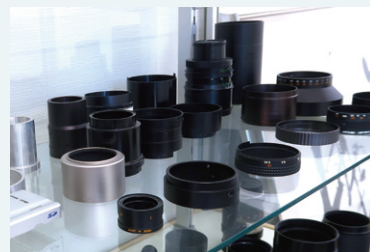
アルマイト処理製品：黒色アルマイトの風合い調整にガラスビーズによるブラスト梨地が使用されています。
