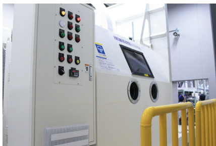
ニューマ・ブラスター (テーブル径: \phi 1200\text{mm} / 耐荷重: 750kg)
