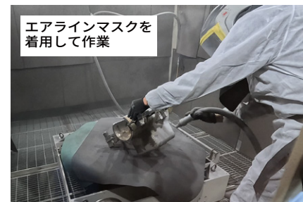
エアラインマスクを着用して作業 ブラスト加工の様子
