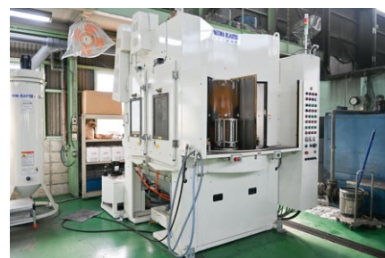
間欠回転テーブル型ウェットブラスト装置 ニューマ・ブラスター
